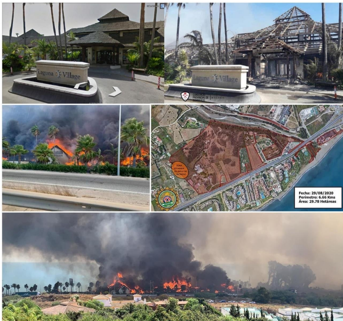
Figura 3.31 - Estapona (Malaga, Andalucia-Spagna), 29/08/2020: incendio boschivo di circa 40 ettari, gli spotting sono precipitati sulle coperture di un villaggio turistico posto ad alcune centinaia di metri che è andato completamente distrutto.
